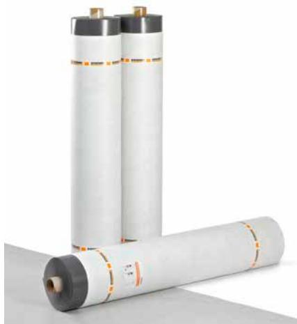
BauderTHERMOFOL U 15 V je 1,5 mm silná PVC-P střešní fólie zesílená umělohmotnou tkaninou, na spodní straně kašírovaná speciálním rounem. To jí propůjčuje vedle osvědčených vlastností využitých fólií možnost lepení k podkladu pomocí schválených PU lepidel.
