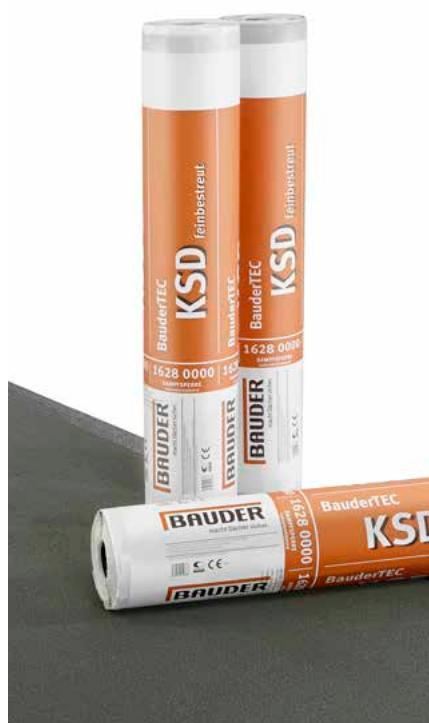
Samolepicí asfaltová (SBS) parozábrana s bezpečným zpracováním spoje a minerálním neklouzavým povrchem. Na spodním povrchu samolepící na trapézové plechy popř. perforovaná stržná folie pro použití jako dělící vrstva na dřevě. Svařením spojů lze zhotovit provizorní hydroizolaci.
