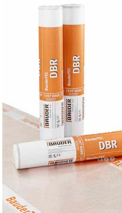
Vysoce kvalitní asfaltová (SBS) samolepící parozábrana splňující požadavky na požární ochranu dle ČSN 730810. Její šířka 1,25 m je ideální pro pokládku na trapézové plechy.
