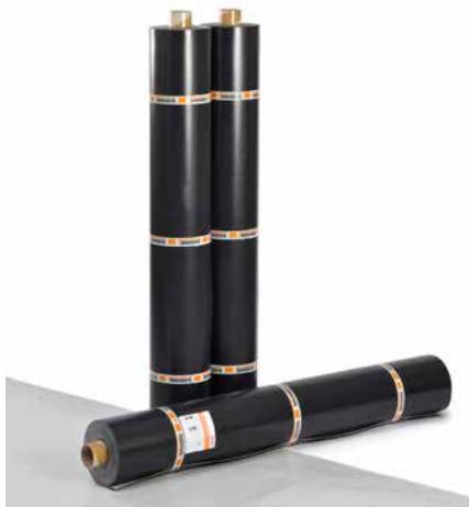
BauderTHERMOFOL M je umělohmotná střešní fólie určená pro volnou pokládku s mechanickým kotvením, vyráběná v tloušťkách 1,2-2,0 mm, zesílená umělohmotnou tkaninou. Ta jí propůjčuje rozměrovou stabilitu, vysokou pevnost a účelu použití exaktně přizpůsobenou tažnost.
