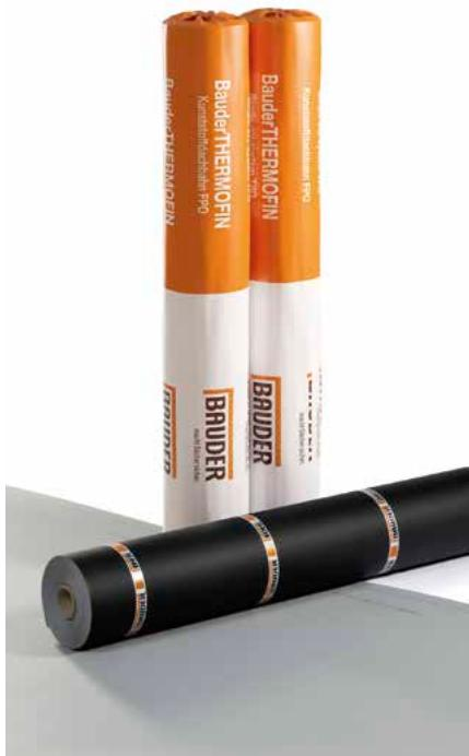
BauderTHERMOFIN F 12/15/18/20 je střešní fólie vyráběná v tloušťkách 1,2 až 2,0 mm zesílená nosnou vložkou ze skleněné rohože. Tato speciální vložka jí propůjčuje vysokou rozměrovou stabilitu, protažení a zaručuje požadované požární vlastnosti.
