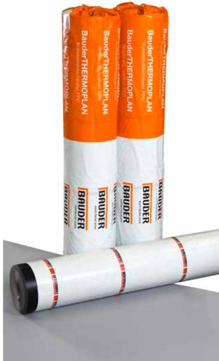
BauderTHERMOPLAN SK je umělohmotná fólie vyráběná v tloušťkách 1,5 a 1,8 mm. Je zesílena speciální nosnou vložkou z tkaniny a skleněné rohože. Spodní povrch je kašírovaný PES rohoží se samolepící vrstvou.
