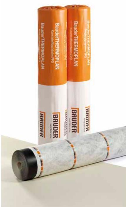
BauderTHERMOPLAN T 15V/18V/20V jsou střešní fólie vyráběné v tloušťkách 1,5 až 2,0 mm, zesílené umělohmotnou tkaninou a doplněné na spodní straně o nakašírované speciální rouno. To propůjčuje vedle osvědčených vlastností zesílených pásů možnost bezpečného lepení pomocí schválených PU-lepidel.
