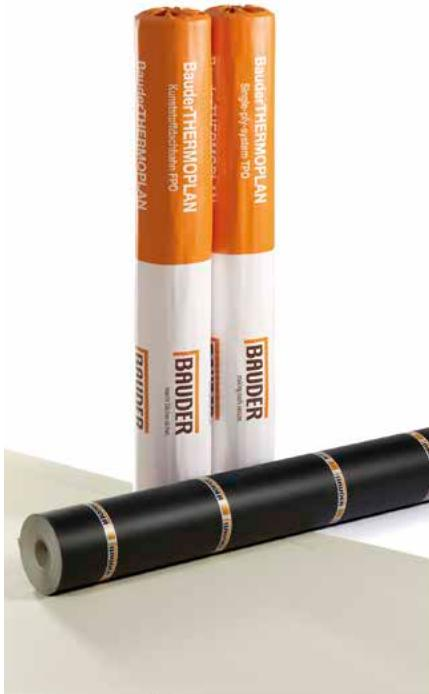
BauderTHERMOPLAN T 12/15/18/20 jsou střešní fólie vyráběné v tloušťkách od 1,2 až 2,0 mm a zesílené umělohmotnou tkaninou. Ta propůjčuje rozměrovou stabilitu, vysokou pevnost v tahu a účelu použití přizpůsobené protažení.
