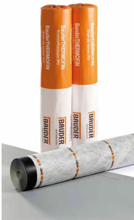
BauderTHERMOFIN F 15V/ 18V/ 20V je 1,5/1,8/2,0 mm silná střešní fólie s nosnou vložkou ze skleněné rohože, na spodní straně kašírovaná speciálním rounem. To propůjčuje vedle osvědčených vlastností zesílených pásů možnost bezpečného lepení pomocí schválených PU-lepidel.
