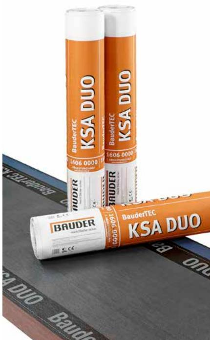
Samolepicí spodní hydroizolační vrstva ze speciálního modifikovaného asfaltu (SBS) s variabilně řešeným podélným spojem: samolepicí ve spoji a ploše, nebo samolepicí v ploše a svařenými spoji. Požadovaný způsob provedení spoje lze na místě rozhodnout a změnit.
